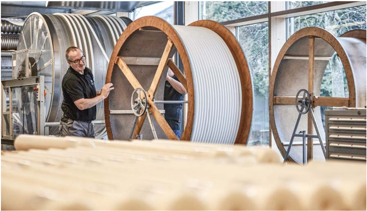
Die Wachs zugmaschine arbeitet nach dem gleichen Prinzip wie vor 300 Jahren.
