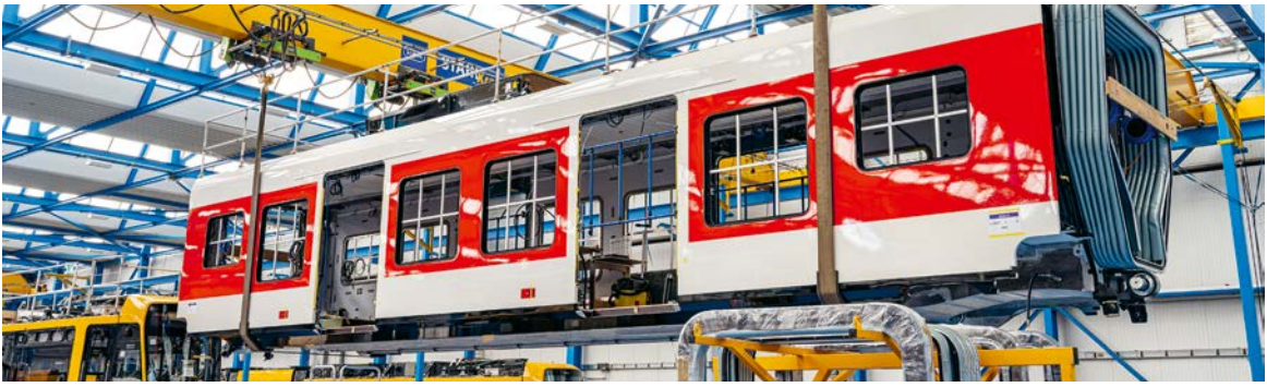
Der Wagenkasten eines Flirt Evo von RegionAlps wird in der Produktionshalle von Stadler umplatziert.
